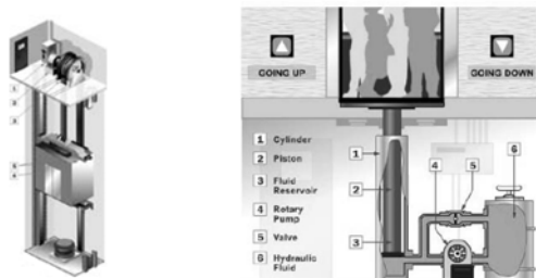
Slika 1. Tipovi liftova: a) lift na uže; b) lift na hidraulični pogon [3]
